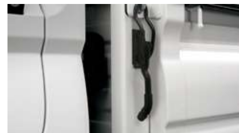
Manija ergonómica de cierre rápido. El resorte interno asegura un movimiento suave de sujeción de las puertas laterales rebatibles.
